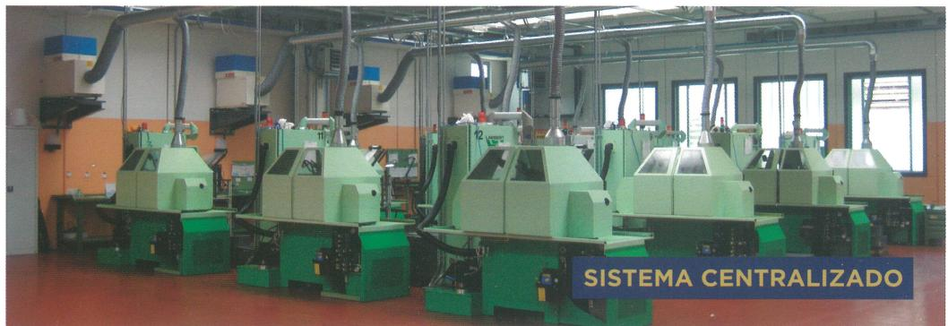
Todos os equipamentos de aspiração de névoa óleo são de montagem e manutenção fácil e rápida.
